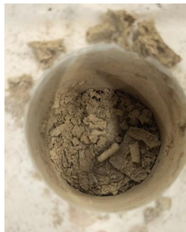
Figuur 35, dakleer na proef zonder cylinder
