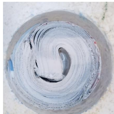
Figuur 31, papier voor proef in retort
