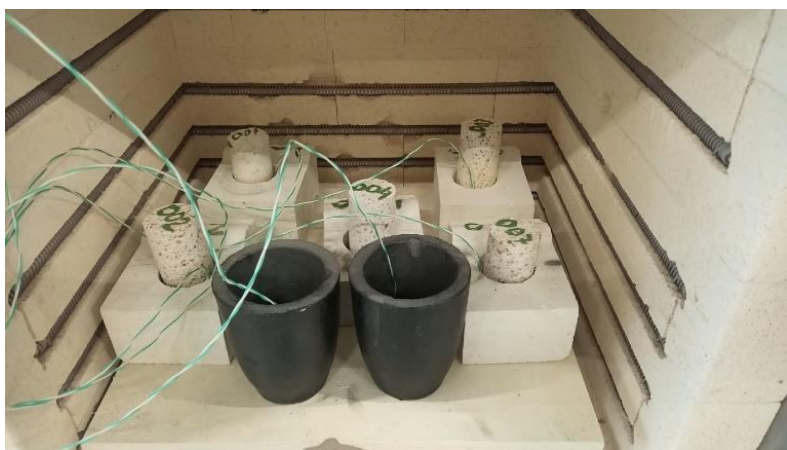
Figuur 4, oven gevuld vlak voor aanvang opwarmen
