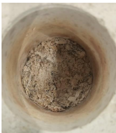
Figuur 21, gemengd plastic restant na proef
