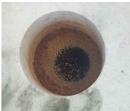
Figuur 8, vast residu van RWZI-slib
