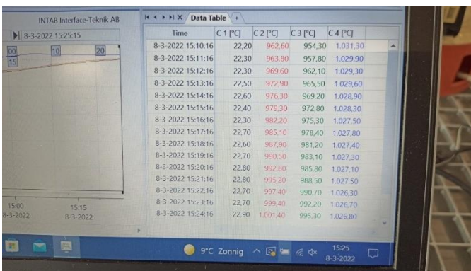
Figuur 6, scherm foto van temperatuur metingen
