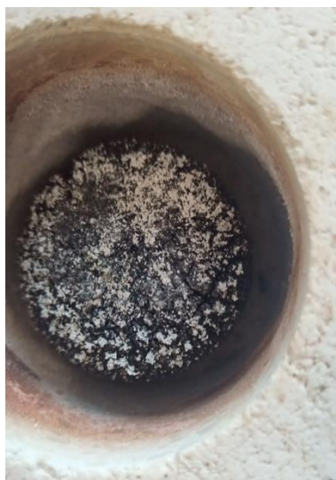
Figuur 36, droge rijst na proef in retort
