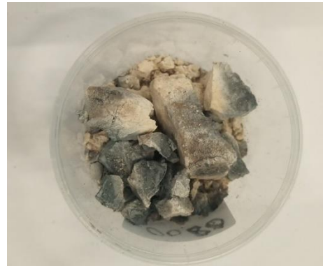
Figuur 15, scrubber sludge b na proef in bakje
