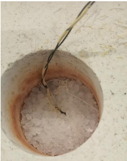
Figuur 5, plaatsing thermokoppel in retort
