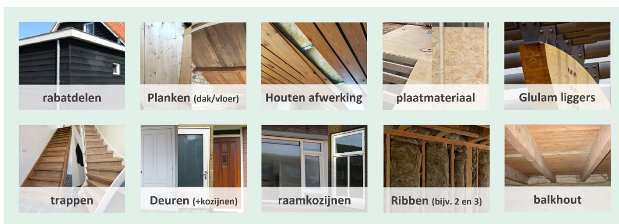
afbeelding 9 verschillende soorten sloophout
